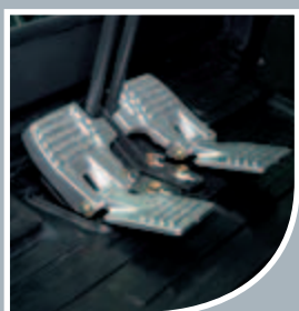
I nuovi pedali di traslazione ergonomici in alluminio fuso assicurano un controllo fluido e sicuro durante la guida della macchina.
