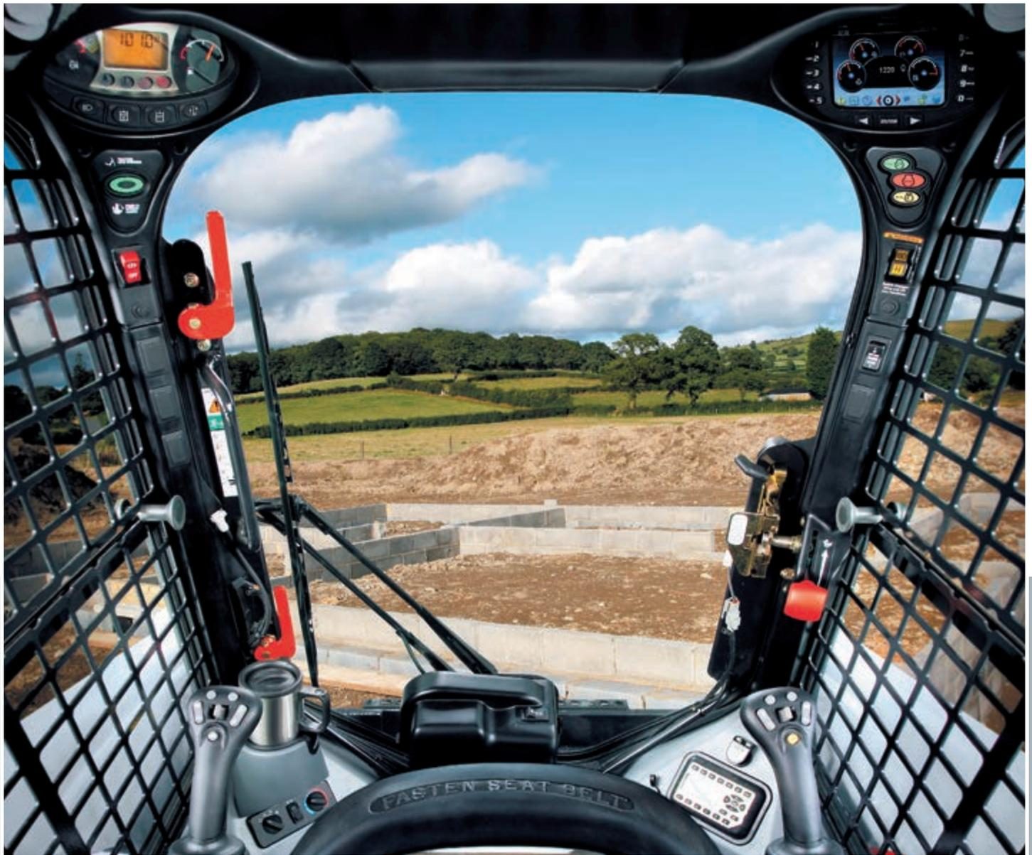
Le pale caricatrici della nuova generazione Bobcat offrono una cabina pressurizzata al vertice della categoria, con una nuova tenuta in un unico pezzo che segue integralmente il profilo dello sportello e si inserisce in un incavo curvo appositamente predisposto, impedendo l'ingresso di sporco e polvere nell'abitacolo. I livelli sonori sono stati ridotti, migliorando ulteriormente il comfort dell'operatore.
