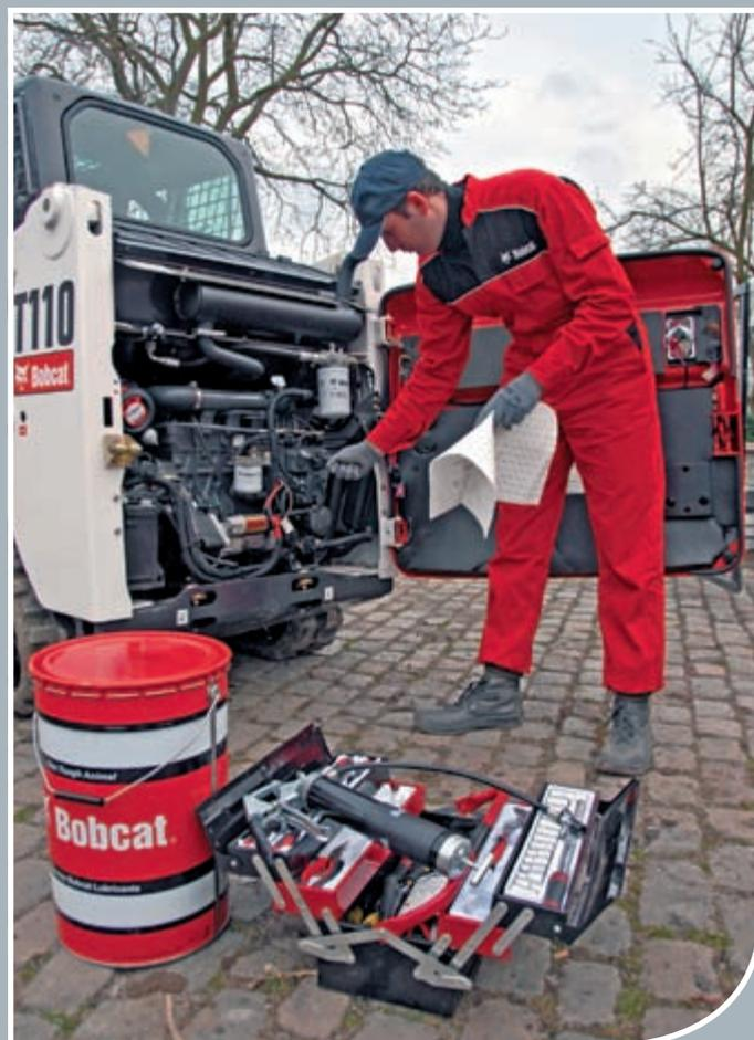
Il motore montato trasversalmente e l'ampio portellone completamente apribile semplificano la manutenzione.
